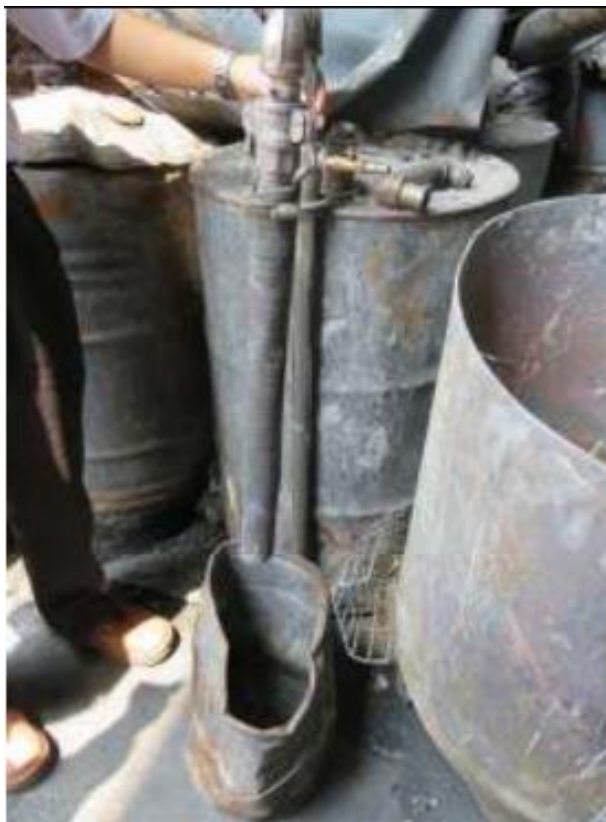
抽取甲苯未接地 因靜電引起火災
