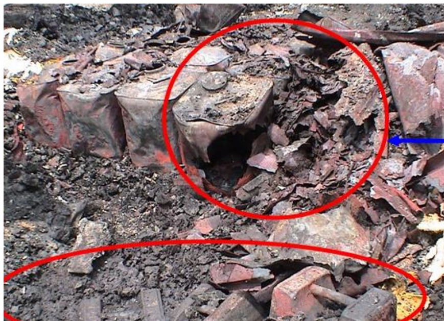
環氧乙烷儲存桶疑似被堆高機戳刺破壞現象
