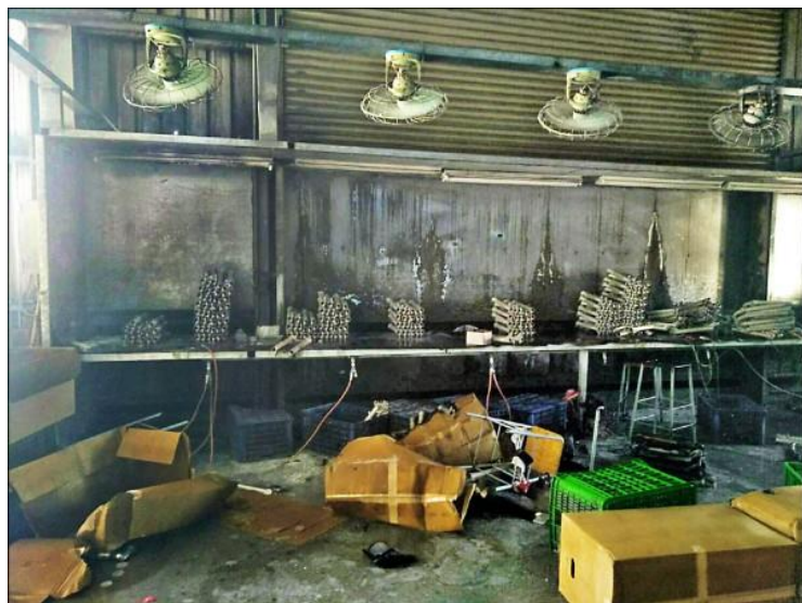
自行車零件加工廠研磨拋光 金屬產生粉塵發生火災
