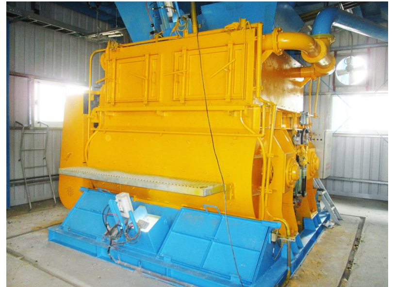
預拌混凝土拌合槽
